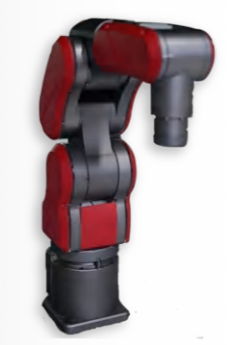
GD60407 Specified Load 4Kg Maximum Arm Span 700mm
