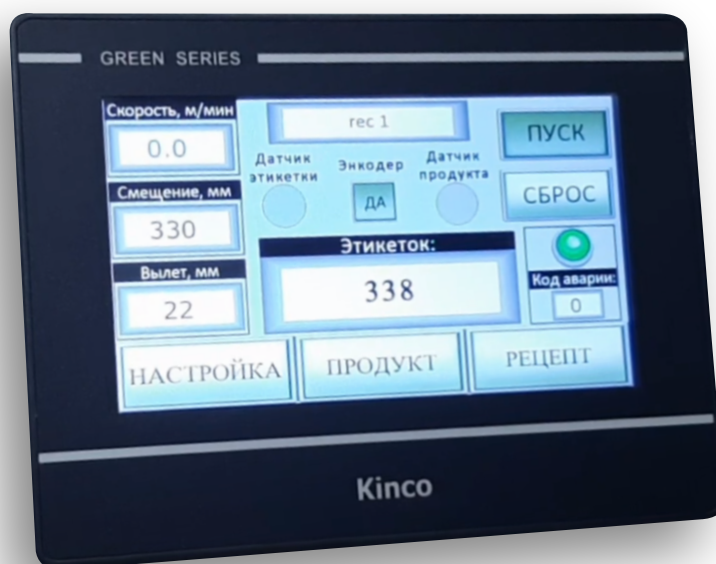
Пример русскоязычного интерфейса панели GL070 этикетировочного автомата
