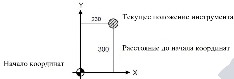
Рис.2.1.7 Система координат, связанная со станком
